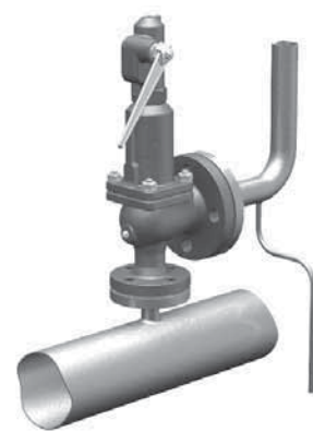
Правильная установка на паропровод
