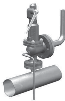
Правильная установка на паропровод
